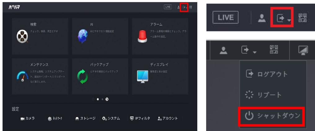
③NVR背面に**電源スイッチ**が搭載されている機種は、シャットダウン後に電源スイッチを切り、電源ケーブルを抜いてください。電源スイッチ非搭載NVRは、シャットダウン後にそのまま電源ケーブルを抜いてください。
