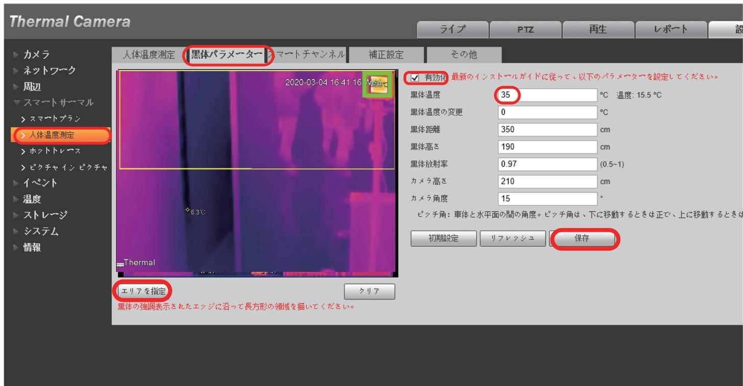
c) ブラックボディの設定温度は 35.0°C(初期値) です。「エリアを指定」 ボタンをクリックしブラックボディの位置を囲うように描きます。画像をダブルクリックすると全画面に拡大します（描画後に元の画像サイズに戻すにはもう一度ダブルクリックします）。
